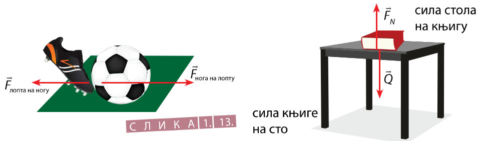
Узајамно деловање тела која се налазе у додиру. Важно: Приказане силе делују на различита тела
