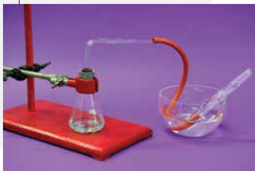
Апаратура за добијање водоника
