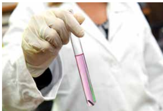
Магнезијумова трака у епрувети с водом после загревања (уз додатак индикатора фенолфталеина)
