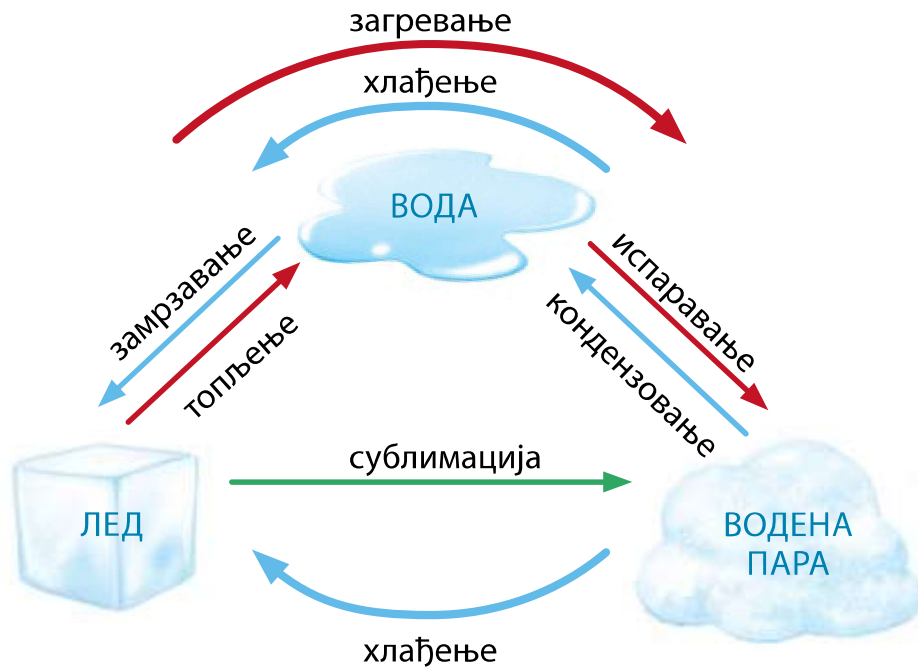
● Промене агрегатног стања воде
