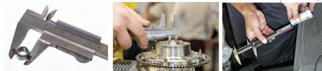
Сл. 4.34. Мерење димензија: спољашње, унутрашње и дубине
