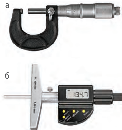
Сл. 4.39. Микрометар: а) мерење спољашњих мера, б) мерење унутрашњих мера
