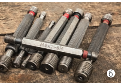
Сл. 4.43. Контролни еталони: а) контролни чешаљ б) контролни чепови
