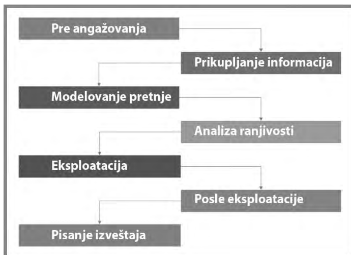
Slika 1.1 – Faze penetracionog testiranja
