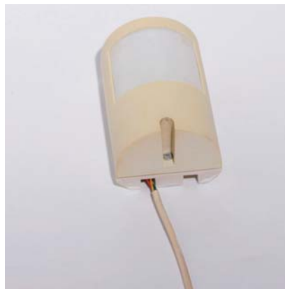
Slika 1-4. PIR senzor pokreta
